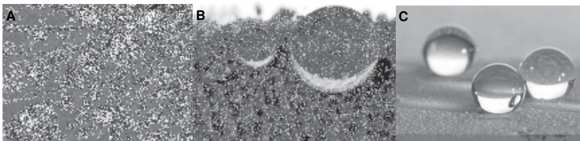
Abb. 7: A und B wasserabweisender Effekt der Lotuspflanze, C bioinspirierte Oberfläche.
