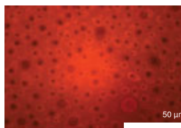
Abb. 62: LRB-Farbstoff 53 auf mit Initiator 50 beschichteter Siliziumdioxidoberfläche.
