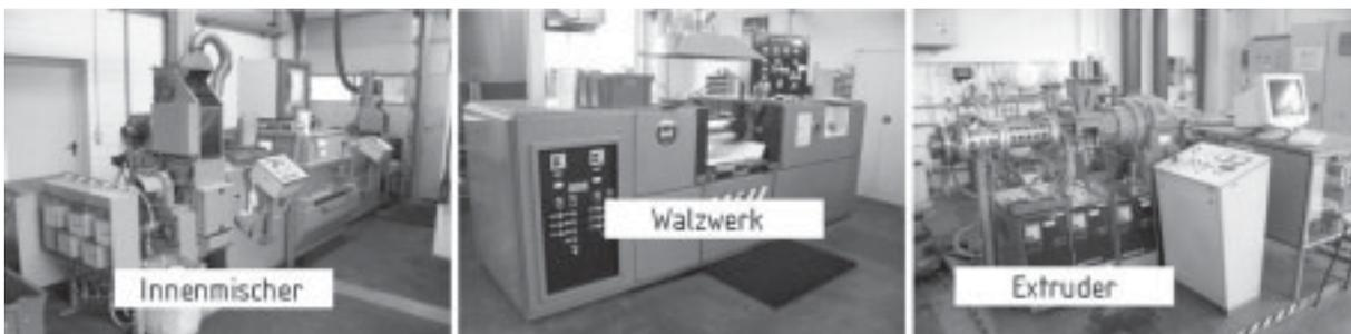
[Bild 4.3](#): Bestandteile der verwendeten Kalandrierlinien
