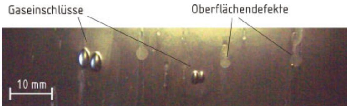
Bild 2.1: Beispiel für Oberflächendefekte und Gaseinschlüsse
