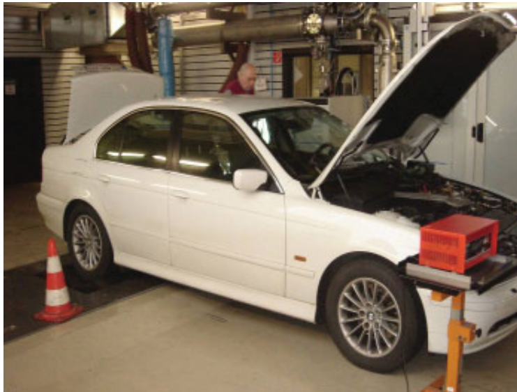
Abbildung 5-9: Prüffahrzeug auf dem Rollenprüfstand (TÜV Nord, Essen).
