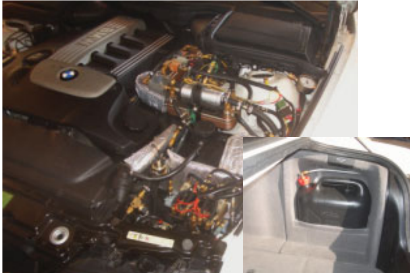
Abbildung 5-11: Das eingebaute SKARABÄUS-Emulsions-Kraftstoff-Systems mit Schnellanreicherung (links), Zusatzwassertank (rechts).
