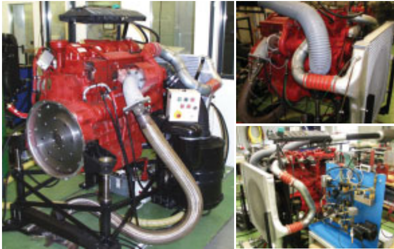
Abbildung 5-37: Nutzfahrzeugdieselmotor der Firma MAN, 5-Zylinder mit Direkteinspritzung, ATL-aufgeladen mit Ladeluftkühlung. Maximale Leistung von 191 kW bei 2000 \text{ min}^{-1} , maximaler Drehmoment von 1050 Nm zwischen 1000 und 1500 \text{ min}^{-1} . Die Einspritzung des Kraftstoffes erfolgt über eine elektronisch geregelte Reiheneinspritzpumpe. Hubraum V_H = 9973 \text{ cm}^3 , Zylinderdurchmesser D = 128 \text{ mm} , Hub S = 155 \text{ mm} , Verdichtungsverhältnis \varepsilon = 17 . Mit eingebauten SKARABÄUS-Mischeinheit (unten, rechts).
