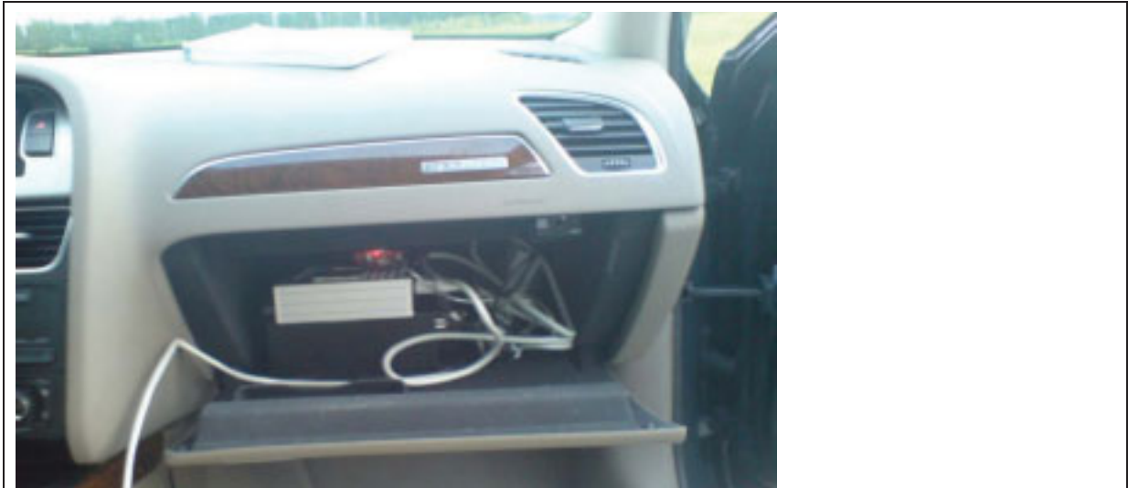
Abbildung 6-3: Unterbringung des CarPC und des DSM im Handschuhfach Quelle: (Eigene Darstellung)
