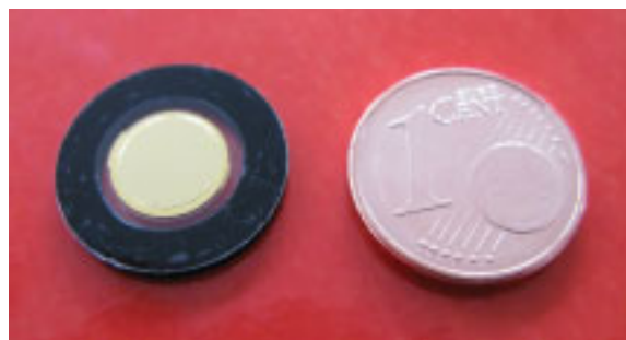
Abbildung 25: Schwingquarzsensoren in Haltevorrichtung im Größenvergleich zu einem 1 Cent Stück.
