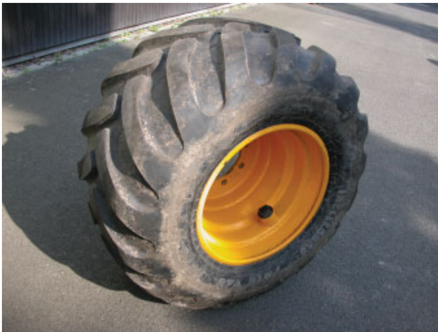
Abbildung III, 3: Rad für die Montage auf der vorderen Bogie-Achse mit der Dimension 600/50 – 22,5 mit neuem Reifen (Trelleborg T 428)
