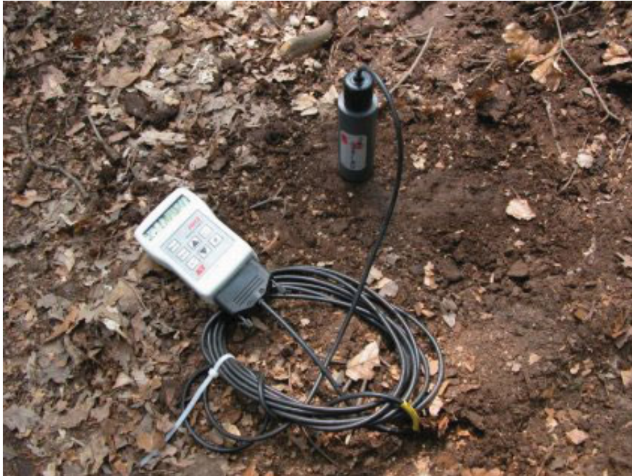
Abbildung 6: Messung des Bodenwassergehalts mit der Theta Probe ML2x und dem Handauslesegerät
