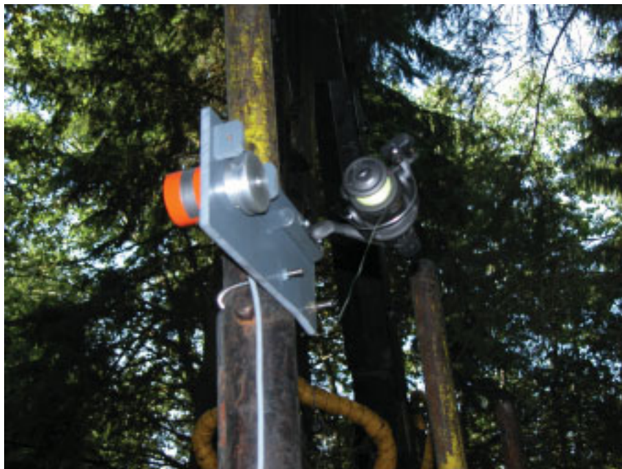
Abbildung 13: Spill-Konstruktion zur Erfassung der tatsächlichen Geschwindigkeit
