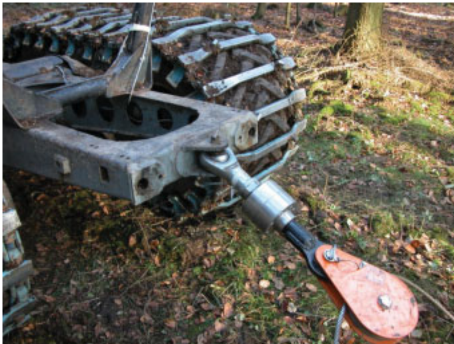
Abbildung 12: Zugkraftmessdose montiert zwischen dem Versuchsforwarder und der Umlenkrolle zur Reduktion der Seilkräfte durch das „Flaschenzugprinzip“
