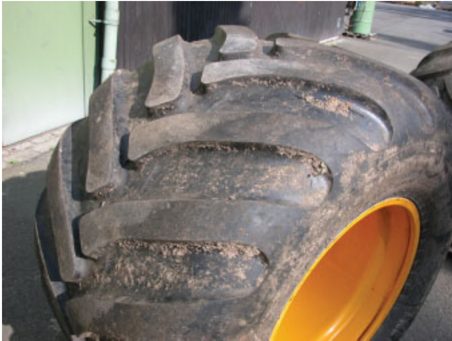
Abbildung III, 4: Rad für die Montage auf der hinteren Bogie-Achse mit der Dimension 710/40 – 22,5 mit neuem Reifen (Trelleborg T428)
