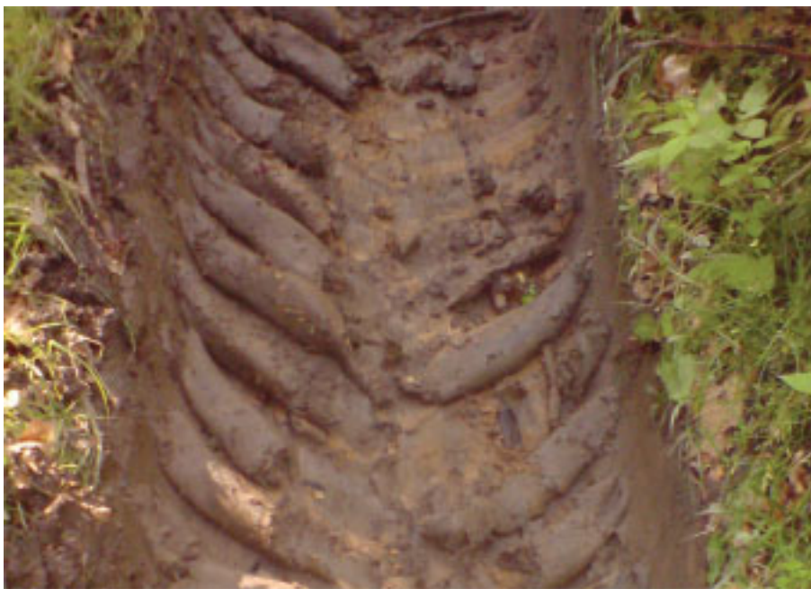
Abbildung 44: Fahrspur nach Befahrung einer Steigung von 23 % mit höherem Schlupf
