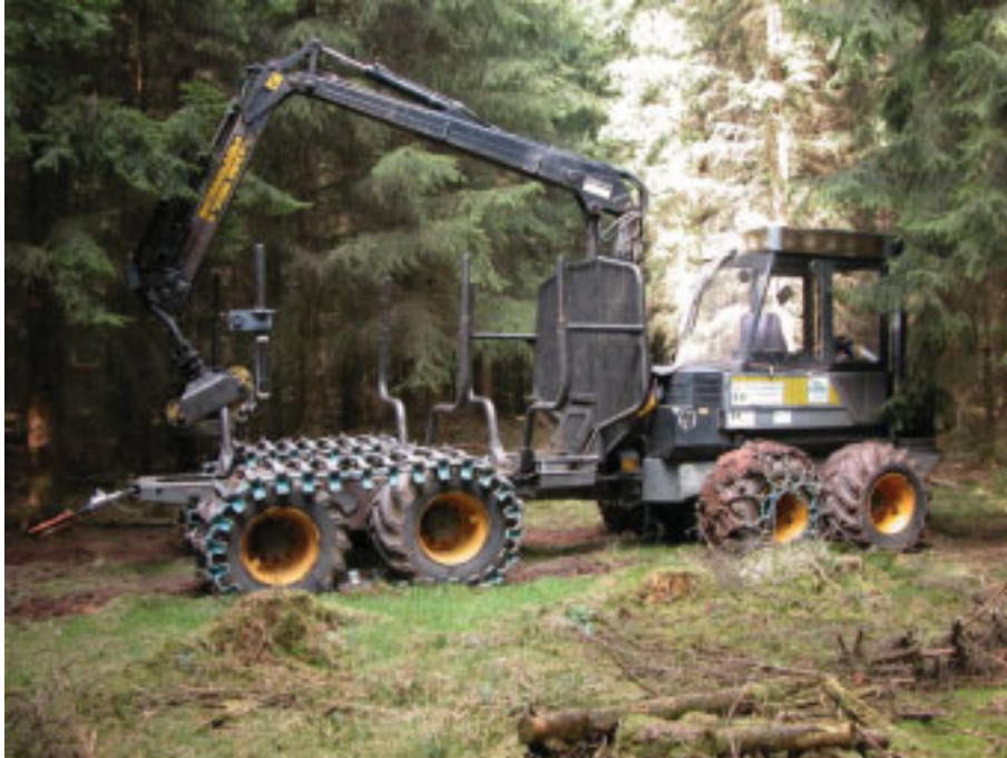
Abbildung 10: Versuchsforwarder Ponsse S10 mit Ketten und Bändern sowie montierter Messtechnik
