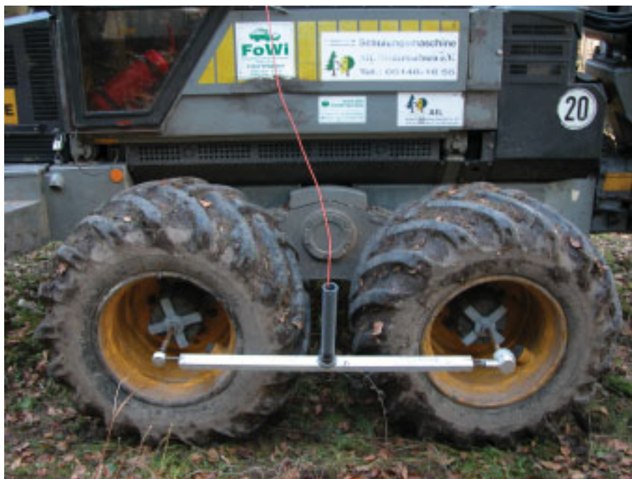
Abbildung III, 1: Räder der vorderen Bogie-Achse mit gebrauchtem Reifen (Nokian TRS LS-2) der Dimension 600/50 – 22,5
