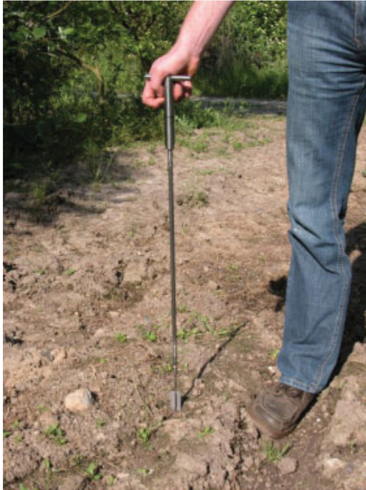
Abbildung 7: Scherfestigkeitsmesser mit halb versenkter Messvine
