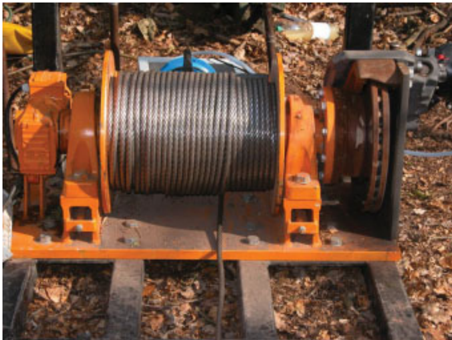
Abbildung 15: Technischer Teil der Verzögerungstechnik bestehend aus Elektromotor, Seiltrommel und Bremsanlage montiert auf dem Grundrahmen
