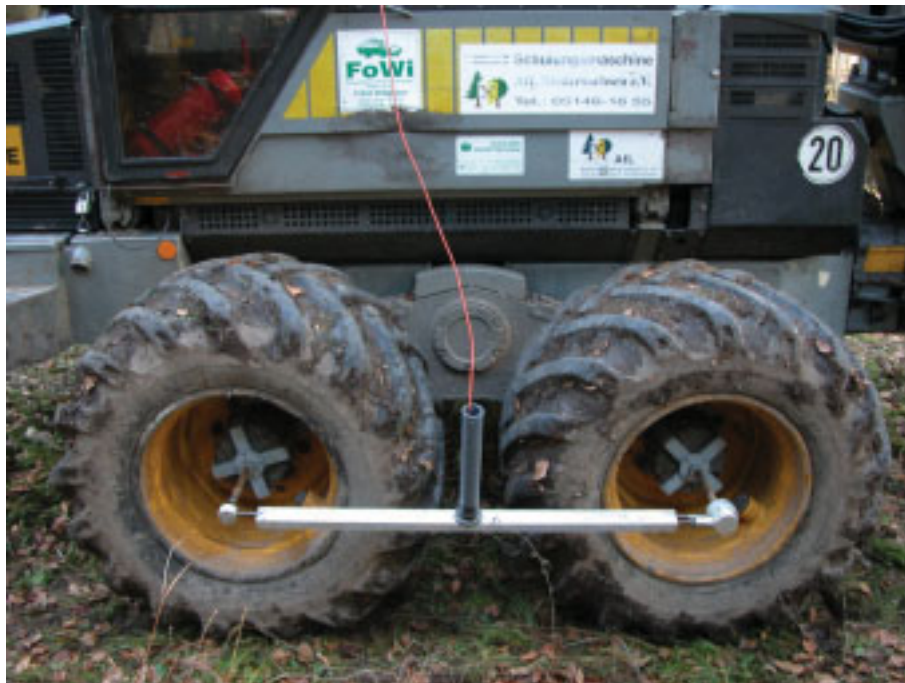
Abbildung 14: Montage der inkrementalen Drehgeber in der Verlängerung der Radachsen zur Messung der theoretischen Geschwindigkeit
