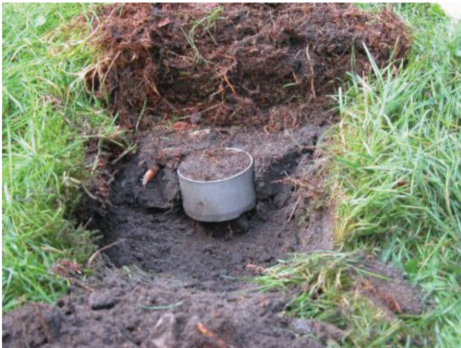
Abbildung 8: Entnahme einer Mineralbodenprobe mit Hilfe eines Stechzylinders (250 cm 3 )
