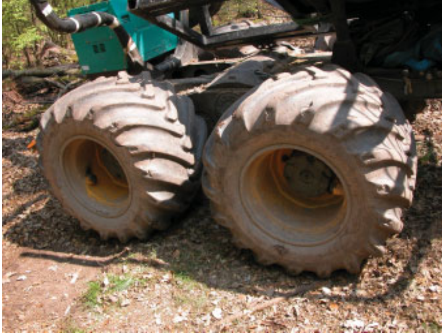
Abbildung III, 2: Räder der hinteren Bogie-Achse mit gebrauchtem Reifen (Nokian TRS LS-2) der Dimension 700/45 – 22,5
