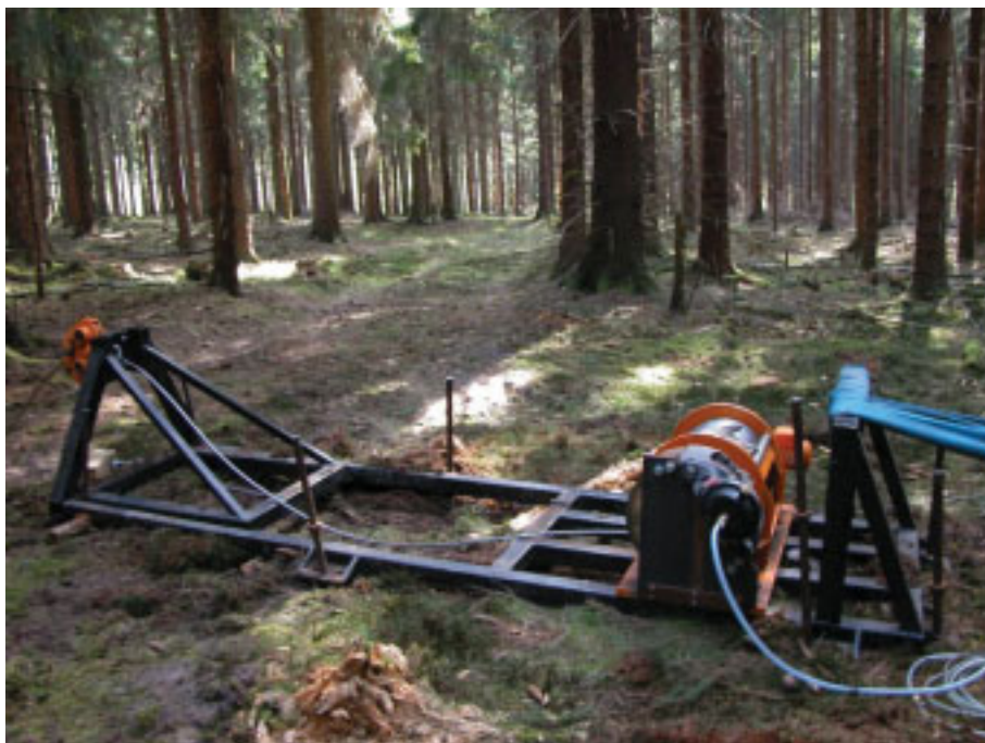
Abbildung 5: Verankerungstechnik für Zugkraftmessungen an Forstmaschinen in aufgebautem Zustand (Eigenkonstruktion des ifa)
