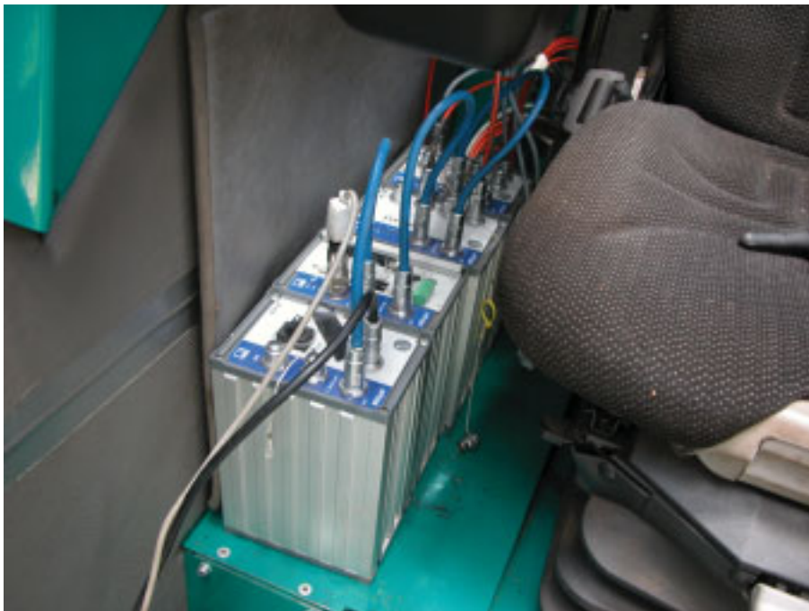
Abbildung 11: MGCsplit Messtechnik (bestehend aus Netzteil, Kommunikationsprozessor und 2 Messverstärkermodulen) in der Fahrerkabine eines Raupenharvesters
