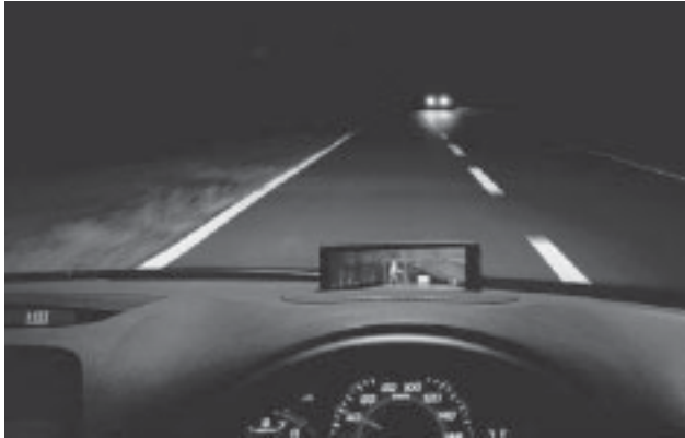
ABBILDUNG 2.4: So sieht der Fahrer eines Honda Legend mit integriertem Intelligent Night Vision System eine Verkehrsszene mit einem Fußgänger und einem entgegenkommenden Fahrzeug.
