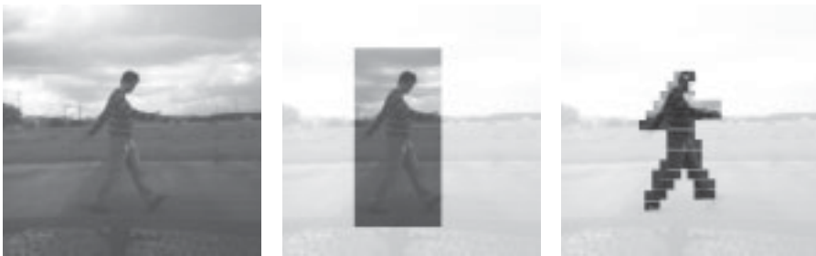
ABBILDUNG 5.4: die 2D-Bildverarbeitung nutzt lediglich einen Ausschnitt des Videobildes (links), und zwar entweder die ROI_1 aus der Bounding-Box (Mitte) oder ROI_2 aus der PMD-Region (rechts)
