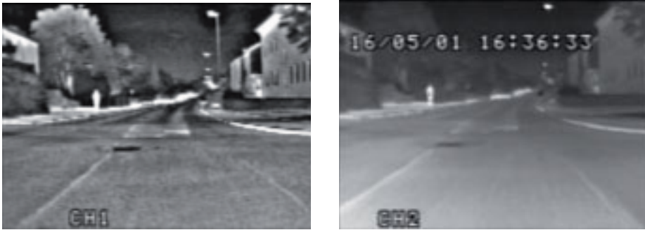
ABBILDUNG 4.11: Typische Ausgabe einer FIR-Kamera mit Wechselstrom-Detektor (links) und Gleichstrom-Detektor (rechts), auf der linken Straßenseite ist jeweils ein Fußgänger zu erkennen
