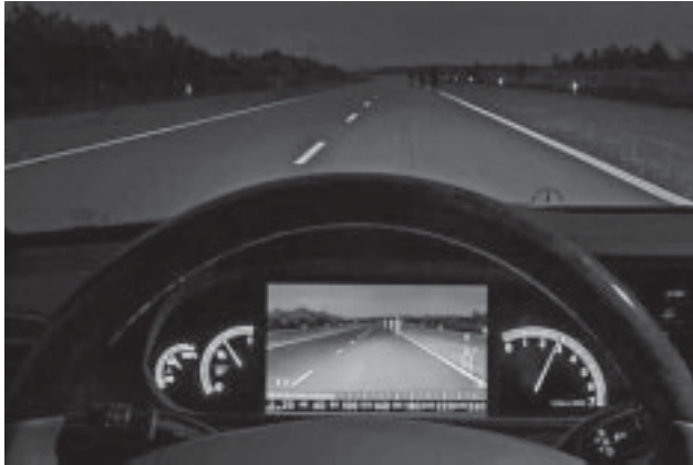
ABBILDUNG 2.1: Night-View-System einer Mercedes S-Klasse aus Sicht des Fahrers, in der Kombiinstrumententafel ist eine Verkehrsszene mit drei Fußgängern zu erkennen
