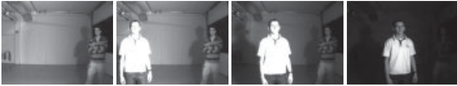
ABBILDUNG 4.6: Beispielsequenz einer ungleichmäßigen, aber über der Zeit gleichbleibenden Ausleuchtung einer Szene mit Personen. Die Person am rechten Bildrand »verschwindet« durch die Belichtungssteuerung der Videokamera.
