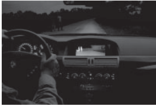
ABBILDUNG 2.3: Night-Vision-System eines 7er-BMW aus Sicht des Fahrers, das Display zeigt eine Verkehrsszene mit zwei Fußgängern und einem Hund
