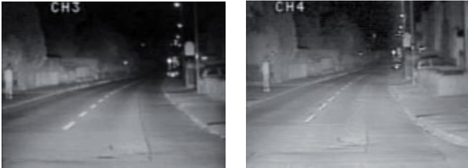
ABBILDUNG 4.10: Typische Ausgabe einer Nahinfrarotkamera mit CCD-Detektor (links) und CMOS-Detektor (rechts), am linken Bildrand ist jeweils ein Fußgänger zu erkennen
