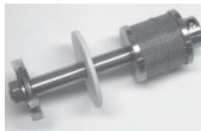
Abbildung 3-16 Bild der Rührwelle mit Korb
