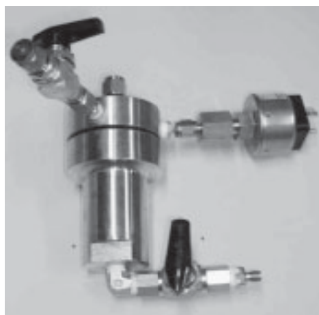
Abbildung 5-4 20 mL Autoklav mit Bodenauslass
