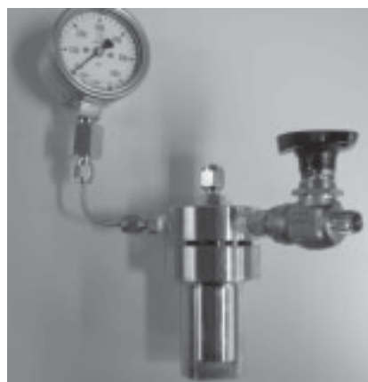
Abbildung 5-3 20 mL Autoklav ohne Bodenauslass
