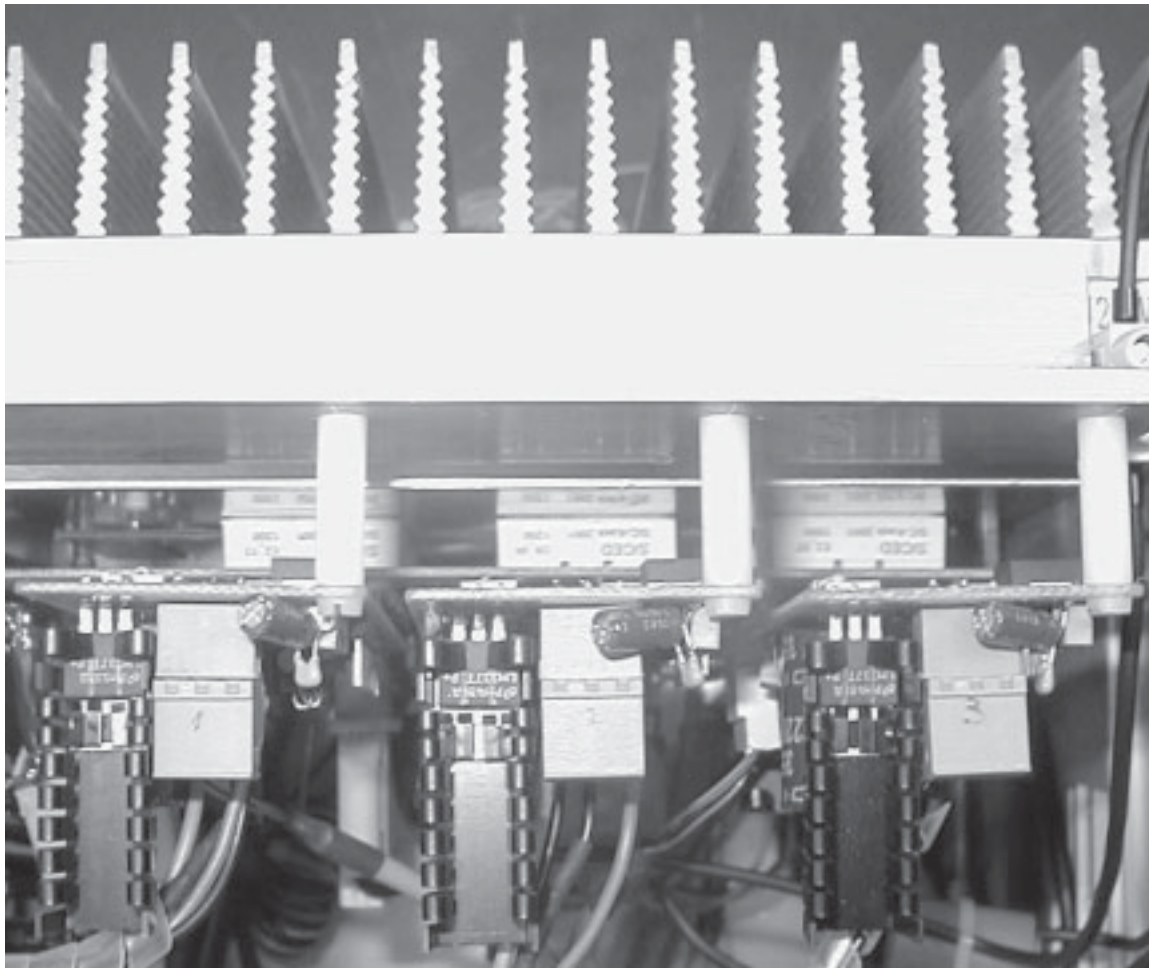
Bild 5.11 Drei SiC-JFETs am Kühlkörper. Darunter die Ansteuerschaltungen.
