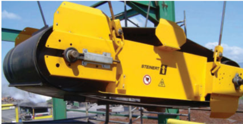
Abbildung 3: Überbandmagnetscheider längs über dem Abwurf angeordnet
