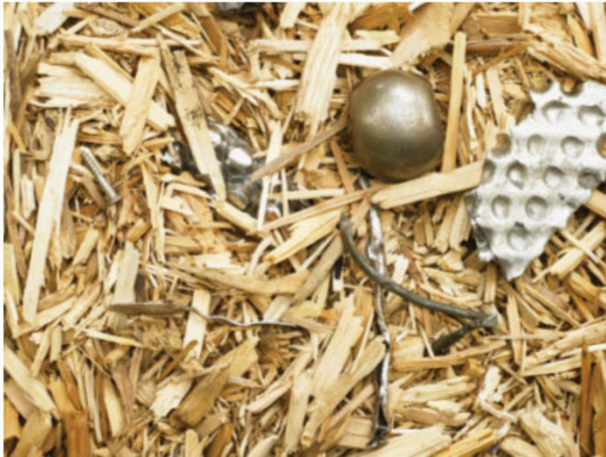
Abbildung 8: zerkleinertes Altholz mit Metall
