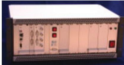
**Abbildung 4.6:** Steuergerät für den Gleitlagerprüfstand
