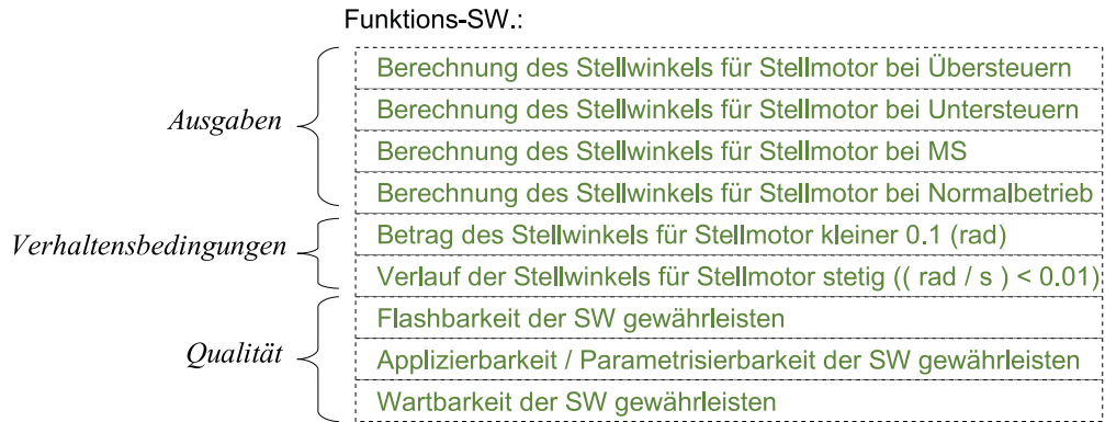
Abb. 2.6: Beispiel einer Anforderungszuweisung zur Komponente Funktions-SW.
