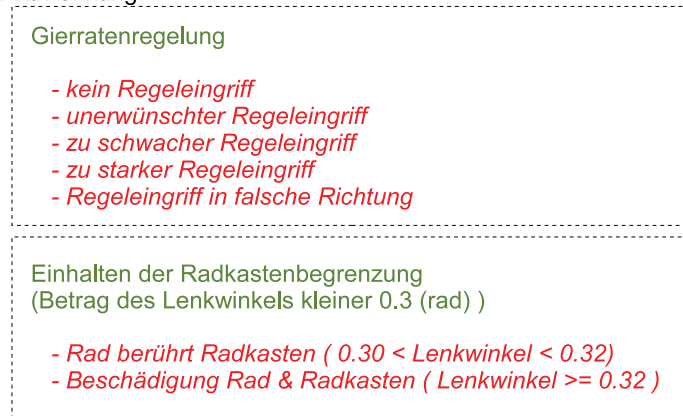
Abb. 2.9: Beispiel einer Fehlerzuweisung
