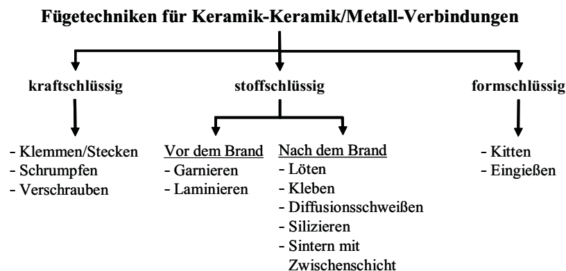
Abb. 4.3 Fügetechniken für Keramik-Keramik/Metall-Verbindungen
