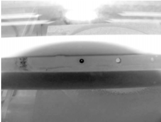
Abbildung 5.7.: Fotografie der pBN-Löcher nach dem Wachstum. Es ist zu erkennen, dass die Löcher teilweise verschlossen sind (Loch ganz links). An den freien Löchern ist das parasitär gewachsene Galliumnitrid bereits abgefallen.
