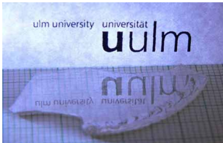
Abbildung 6.17.: Spontan abgelöste, 800 µm dicke freistehende Galliumnitridprobe. Durch den Showerheadschutz aus Mo, siehe Abschnitt 5.2.2, konnte die Bildung inverser Pyramiden komplett unterdrückt werden. Die exzellente Oberfläche ist gut an der Spiegelung des Universitätslogos zu erkennen.
