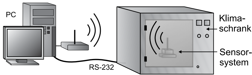
Abbildung 5.3: Messanordnung zur Kalibrierung über die relative Luftfeuchte.
