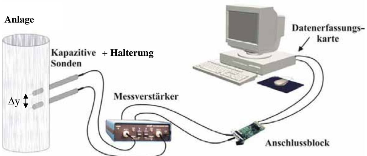
Abbildung 5.3: Prinzipieller Aufbau des eingesetzten kapazitiven Messsystems
