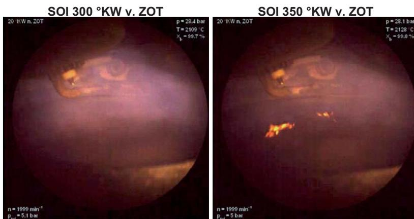
Bild 19: Endoskoptaufnahmen des Brennraums zum Zeitpunkt 20 °KW n. ZOT
