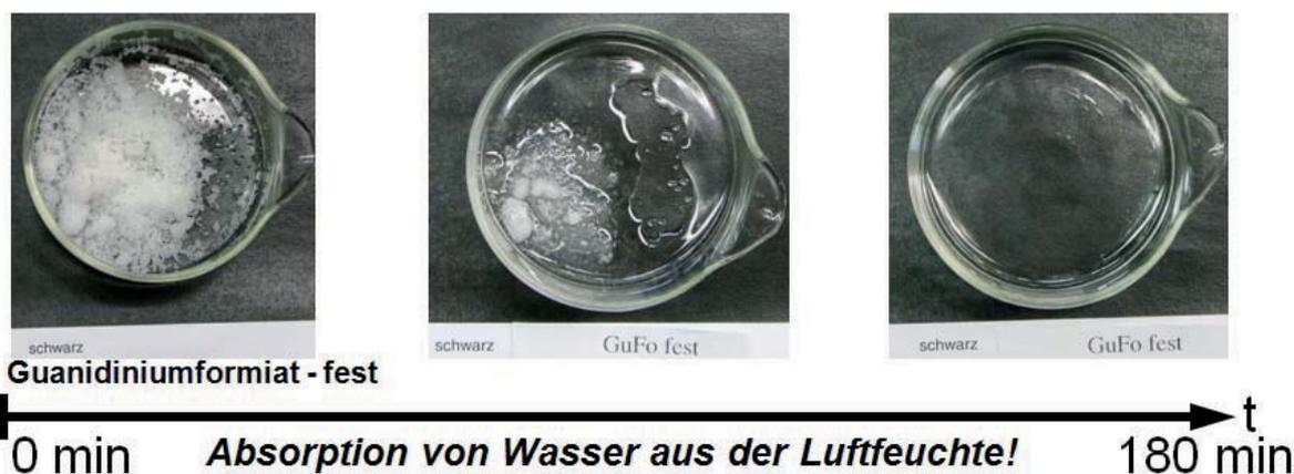
Abbildung 1.1: Wasseraufnahme durch Guanidiniumformiat
