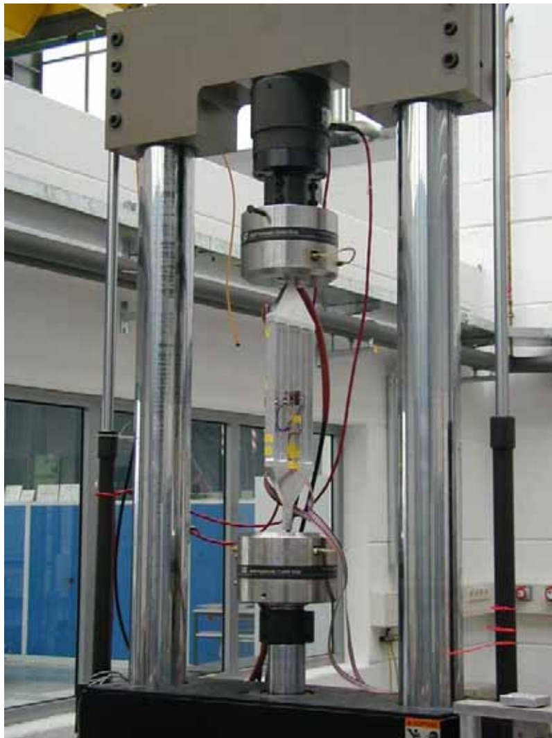
Abbildung 14: Versuchsaufbau, Prüfmaschine MTS 319.25 mit eingebauter Probe
