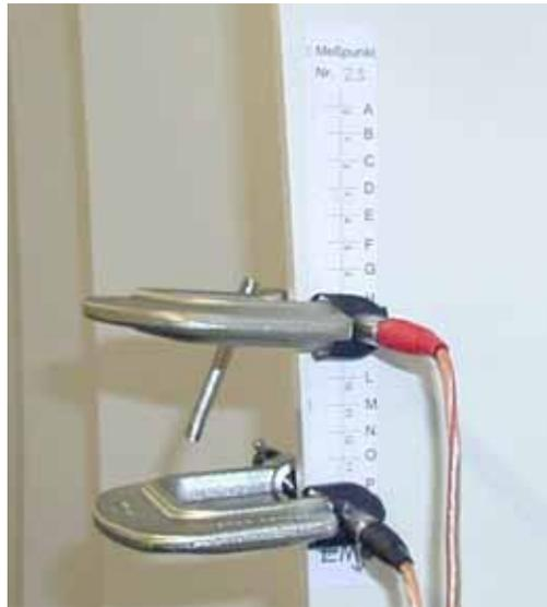
Bild 3.7: Anschluss der Kontakte am Messobjekt
