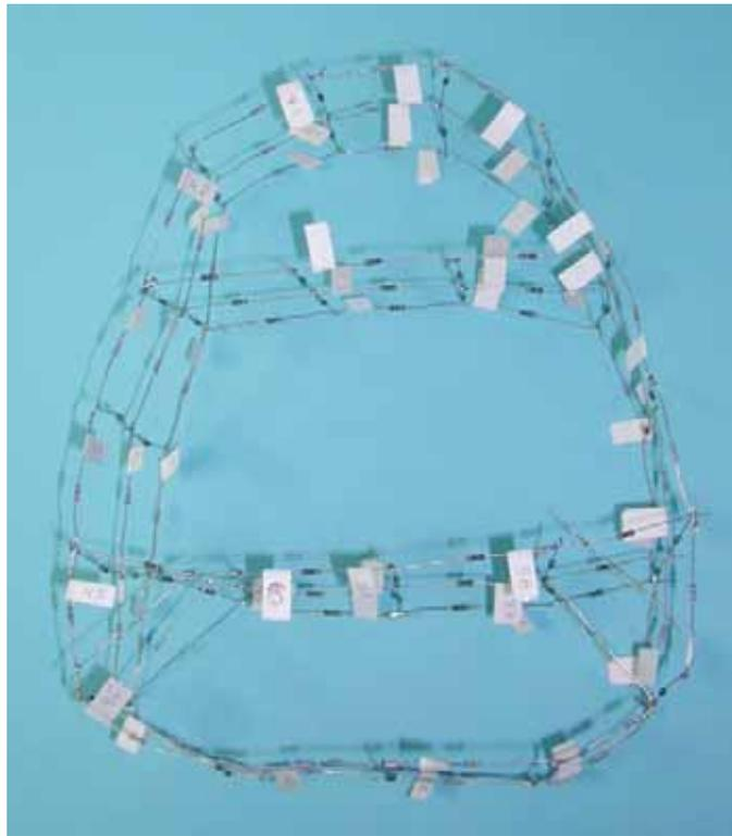
*Bild 3.17: Laboraufbau des Widerstandsnetzwerkes zur Demonstration der Methode des Gleichstromersatznetzwerkes*
