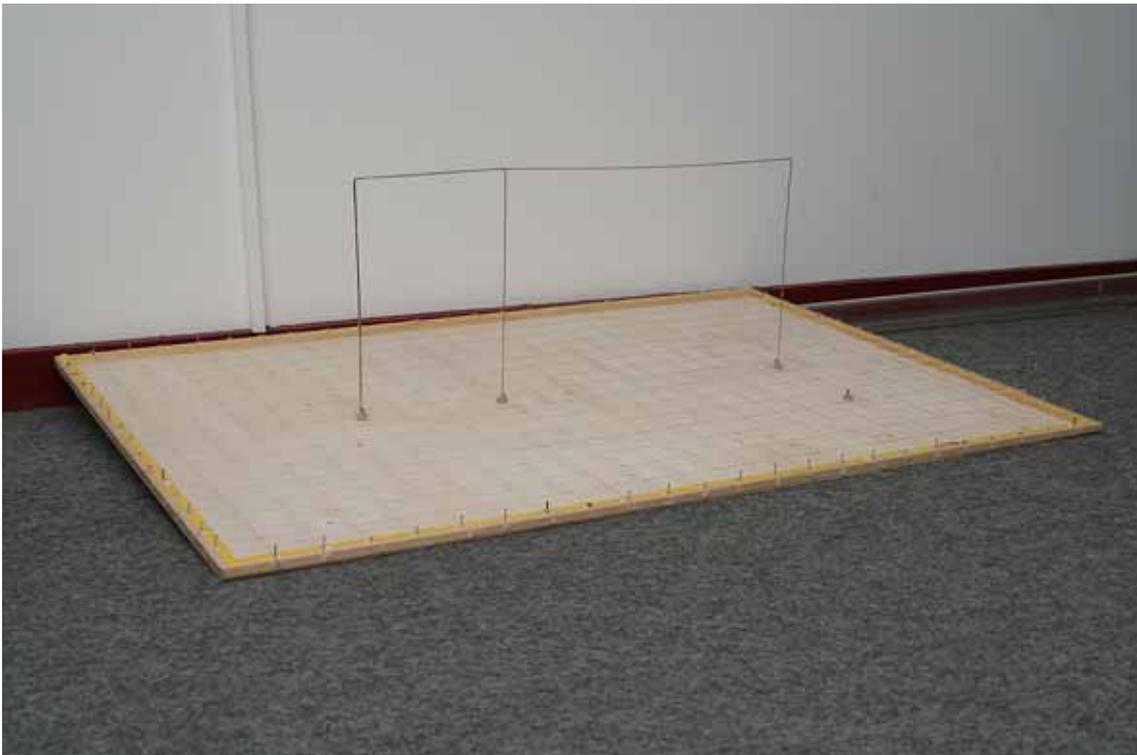
*Bild 3.24: Leiteranordnung aus Massegitter und Hinleiter*
