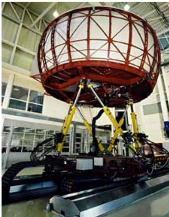
Bild 2.5: DaimlerChrysler Fahrsimulator mit Translationssystem [21]
