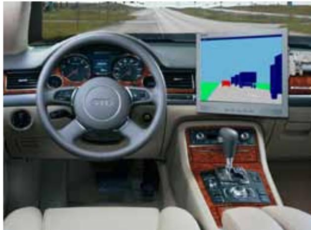
Bild 2.9: Verkehrssimulation Pelops in einem Testfahrzeug
