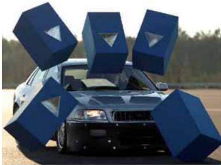
Bild 2.10: Ersatzobjekte für unbewegten Fremdverkehr [43]
