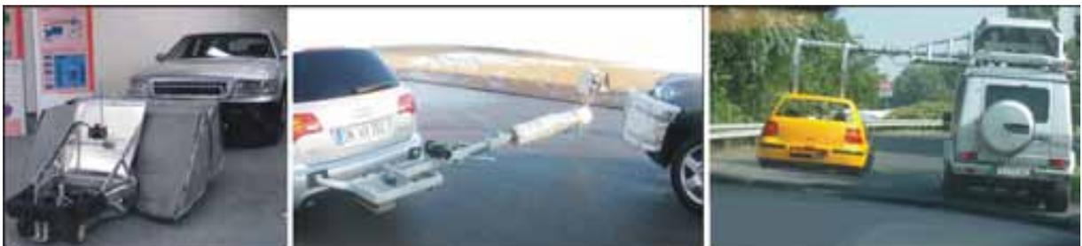
Bild 2.11: Ersatzobjekte für bewegten Fremdverkehr
