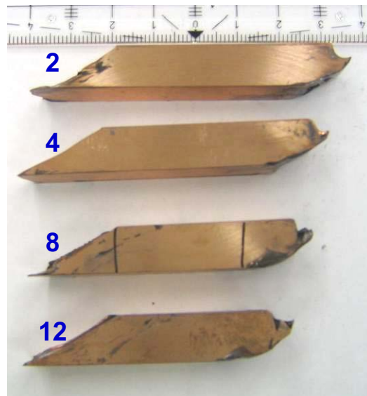
Abb. 4.7: Reinkupfer ECAP-Proben nach 2, 4, 8 bzw. 12 Durchgängen.
