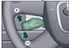
Sie können die Wunschgeschwindigkeit erhöhen, indem Sie den Bedienhebel nach oben drücken (+), und verringern, indem Sie ihn nach unten bewegen (-).
