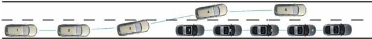
Bild 4.27: Diskretisierung der Spurwechseltrajektorie
