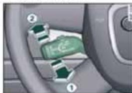
Um ACC einzuschalten, ziehen Sie den Bedienhebel am Lenkrad zu sich (Position 1 in der Abbildung links).
