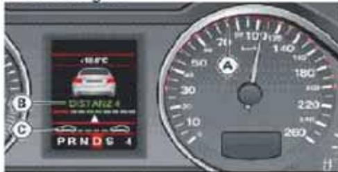
Die ACC-Anzeigen befinden sich im Tachometer (A) und im Display (B). Vorübergehende Informationen werden in der Infozeile (C) angezeigt.
