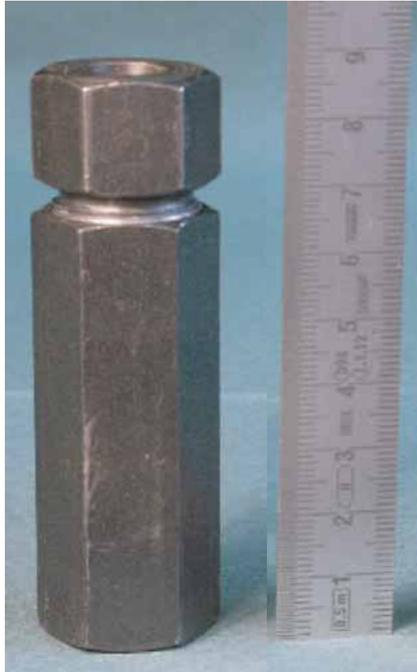
Abbildung B.1: Bild der am ILL entwickelten und am HMI benutzten Druckzelle für Neutronenstreuung. Es handelt sich hierbei um eine Clamped-Pressure-Cell aus CuBe, die im Unterschied zu den anderen verwendeten Zellen aber nur von einer Seite geöffnet werden kann und damit sehr viel schwieriger zu handhaben ist, was das Entladen der Zelle betrifft.
