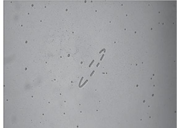
**Abb. 5.11:** Lichtmikroskopische Aufnahme eines Versetzungsrings (50-fache Vergrößerung) (Probe 13097/2).
