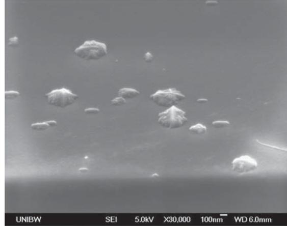
**Abb. 5.9:** Polykristalline Ausscheidungen durch unzureichende Substratreinigung (Probe 19097/1).
