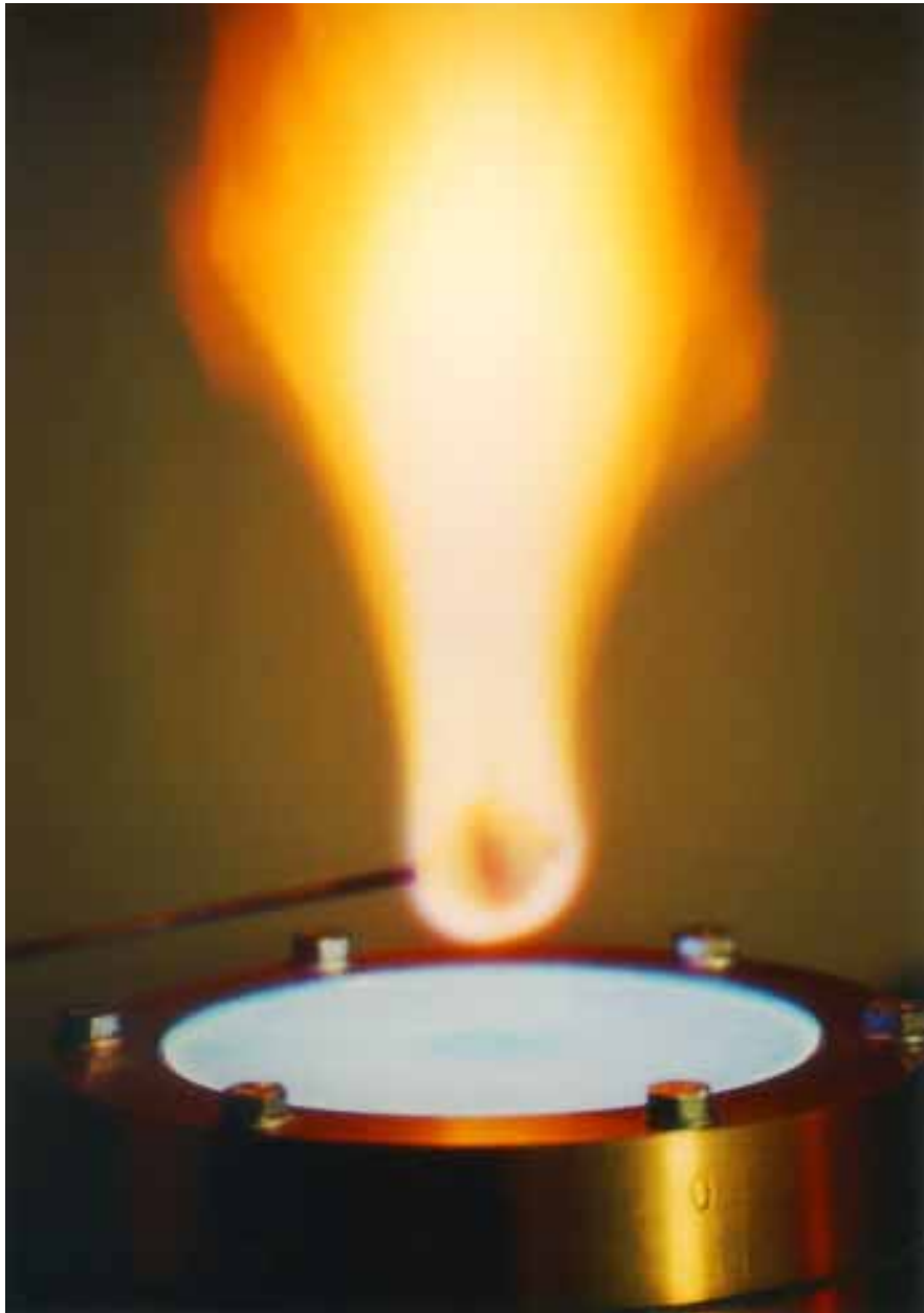
Abbildung 2.3: Holzprobe über der blauen Versorgungsflamme. Für die Fotografie wurde der experimentelle Aufwand auf das Wesentliche beschränkt (Keine Abschirmung von Falschluf, keine Strömungsvereinheitlichung, keine definierte Einspannung und Flammenabstand, zu mageres Versorgungsgas, zu starke Gewindestange u.v.m.) und das Holz von Hand über den Brenner gehalten. Das eigentliche Experiment ist weniger spektakulär, dafür aber definierter.
