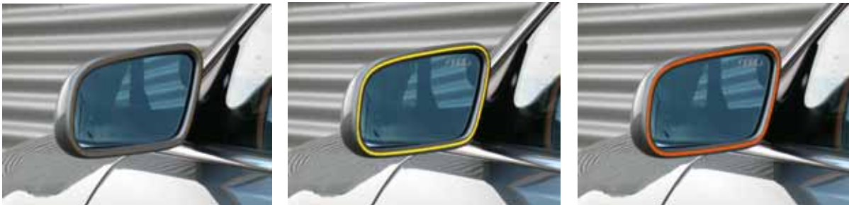
Bild 46: Außenspiegelanzeige im Versuchsfahrzeug (unaktivierter Zustand (li.), gelbe Informationsstufe (mi.), rote Warnstufe (re.))
