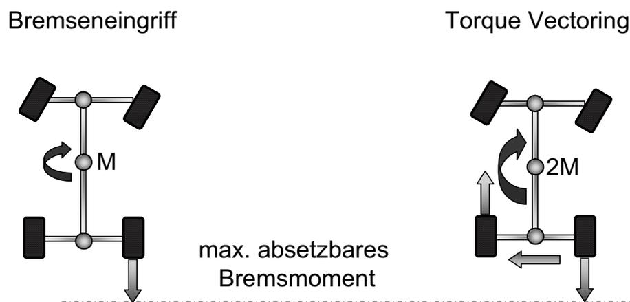
Abb. 5-4: Potentialvergleich zwischen Bremseneingriff und Torque Vectoring für einen Untersteuereingriff in einer Rechtskurve beim freien Rollen (ausgekuppelt)
