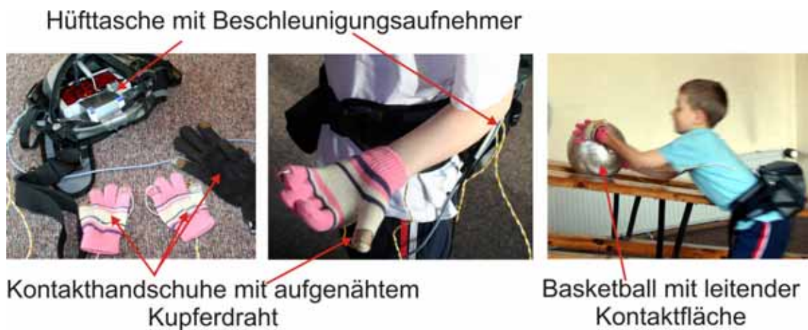
Abbildung 14: Messaufbau zur Validierung des Tests der Reaktionsfähigkeit. Mit Hilfe eines durch Kontakt mit dem Basketball zu schließenden Stromkreises wird die Messung getriggert. Aufgenommen wird die Beschleunigung des Körpers durch einen in einer Hüfttasche angebrachten Beschleunigungsaufnehmer.
