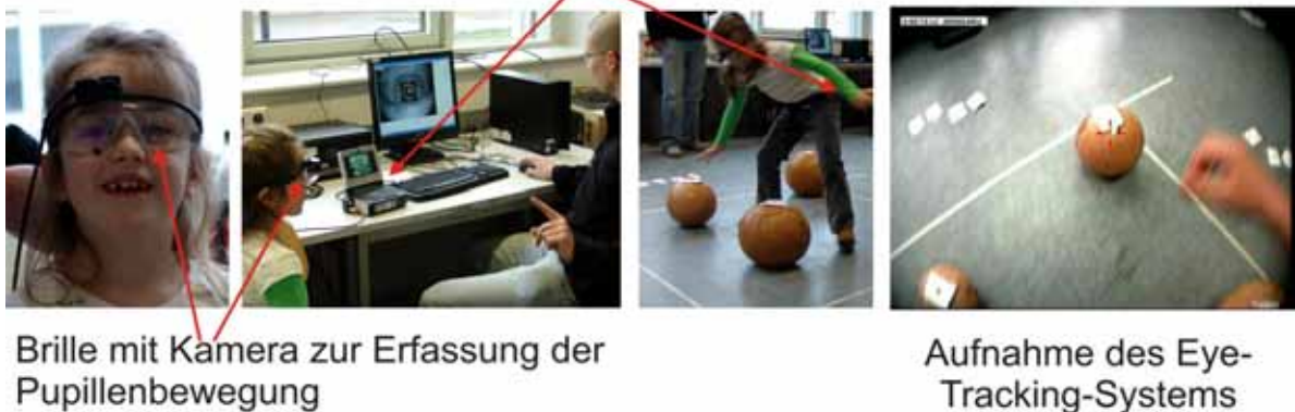
Abbildung 13: Eye-Tracking-System „Mobile-Eye“ zur Validierung des Tests der Orientierungsfähigkeit: Mit Hilfe der genauen Bestimmung des Blickverhaltens können innerhalb der Durchführung des Tests Zeiträume der Orientierung und Zeiträume der Handlung bestimmt werden.
