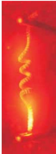
**Abbildung 6.17:** Bogenansatz nach einigen Betriebsminuten
