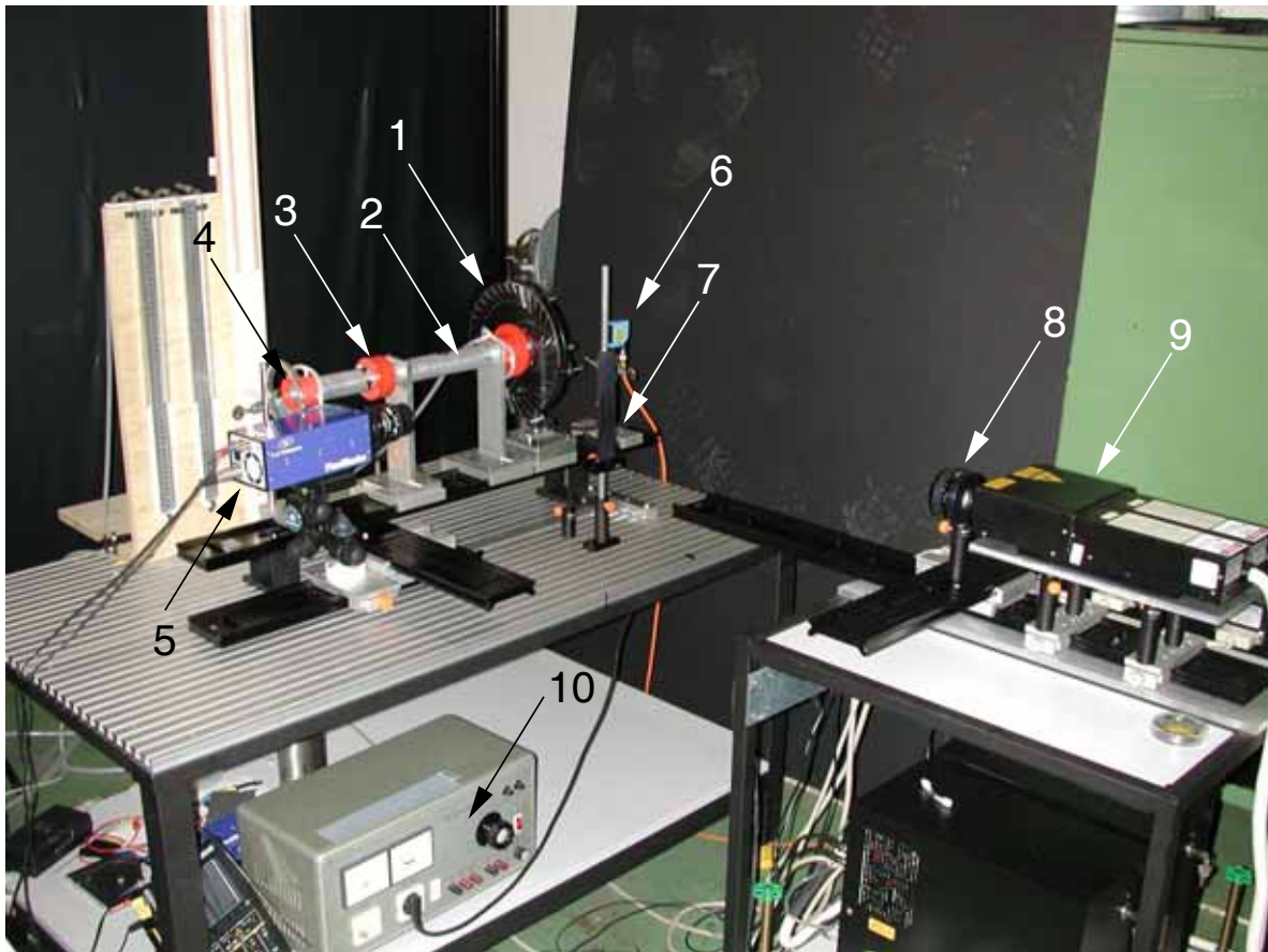
Abbildung 3.2: Bild des Versuchszustandes ( 1 Gebläse mit Diffusor, 2 Ansaugstrecke, 3 Drossel, 4 Einlaufmessdüse, 5 PIV-Kamera, 6 Drehzahlmesser, 7 Spaltblende, 8 Laser-Lichtschnittoptik, 9 Doppelpuls-Laser, 10 Stelltransformator, nicht sichtbar: Auswerte- und Steuerrechner sowie Leistungsmesser)
