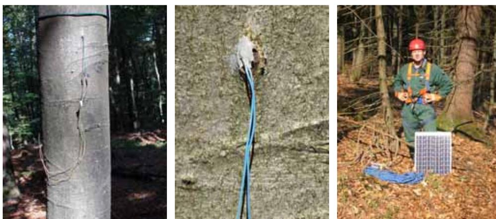
Abb. 22 bis 23: Temperaturmessfühler in der Rinde (jeweils an der Süd- und Nordseite von 5 Buchen wurden in BHD Höhe Temperaturfühler in die Rinde eingebracht)
