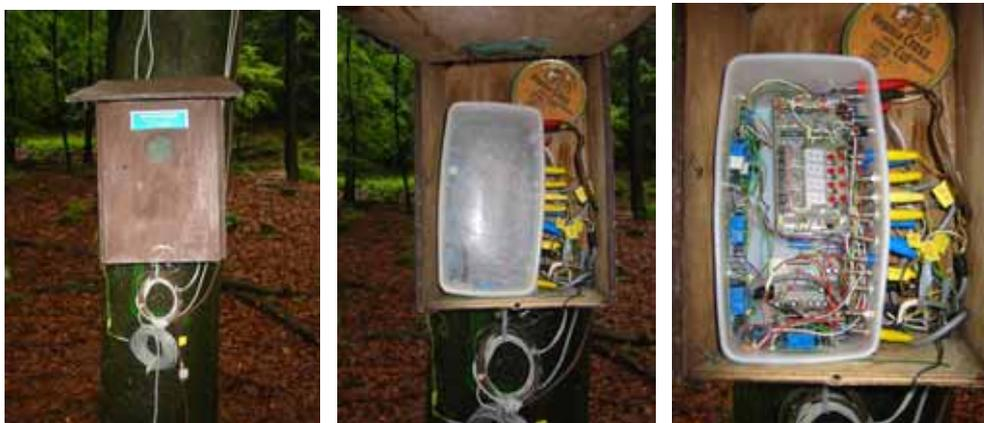
Abb. 19 bis 21: Mikroprozessor zum Messen der Rindentemperaturen; (In einem als Vogelhäuschen getarnten Kasten war der Prozessor in einem Kunststoffbehälter untergebracht)
