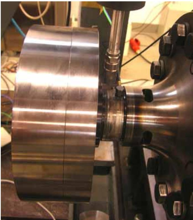
**Bild 20:** Aufbau zur Bestimmung der Vierpolparameter zwischen dem Sitz der Wellensensoren und dem Lagersitz auf der Welle mit Zusatzmasse
