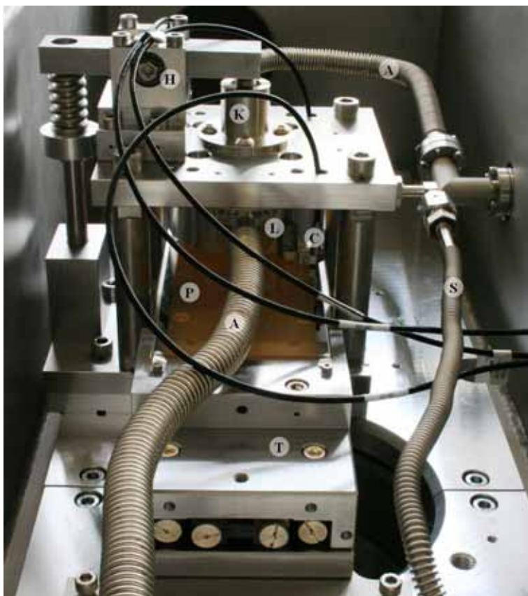
Abbildung 6.2: Experimentalstand ES3 zur Bestimmung der Gasabgabe
