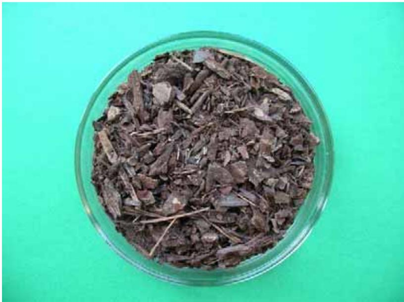
**Abb. 4.2:** Fichtenrinde industriell in einer Hammermühle zerkleinert
