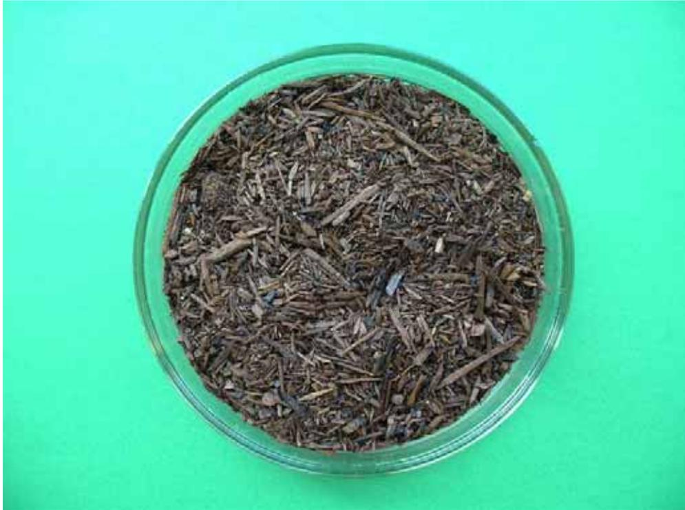
**Abb. 6.2:** Extrahierte Fichtenrinde in Abmischung mit thermohydrolytisch aufgeschlossenen Spanplatten nach ihrer Kompostierung
