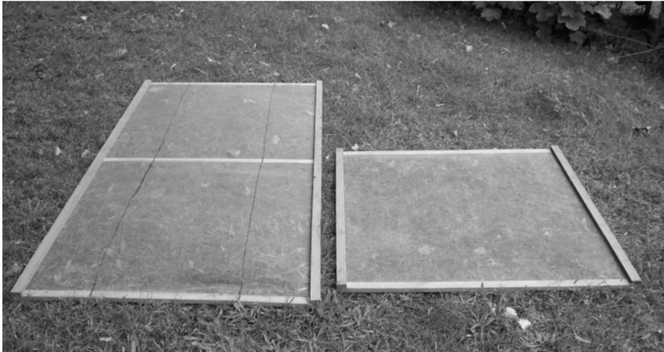
Abb. 32: Gazerahmen (links 2m<sup>2</sup>, rechts 1m<sup>2</sup>)
