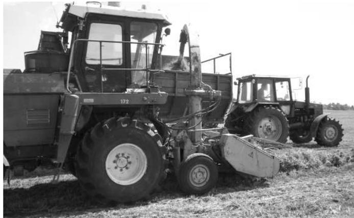
Abb. 11: Anbauhäcksler mit dem Universalfahrzeug Typ POLES`E im Einsatz
