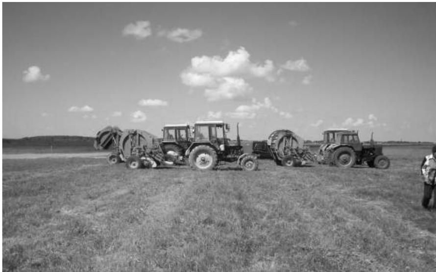
Abb. 10: Sammelpressen Typ PRF, aggregiert mit Traktoren Typ MTZ
