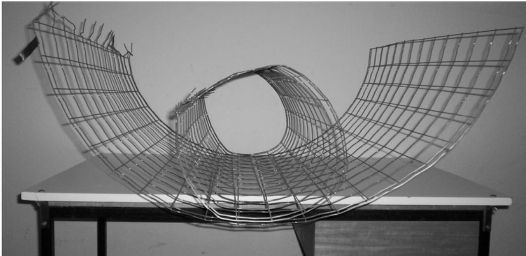
Abb. 31: Maschendrahtrollen für Erzeugung des Spiralschwades
