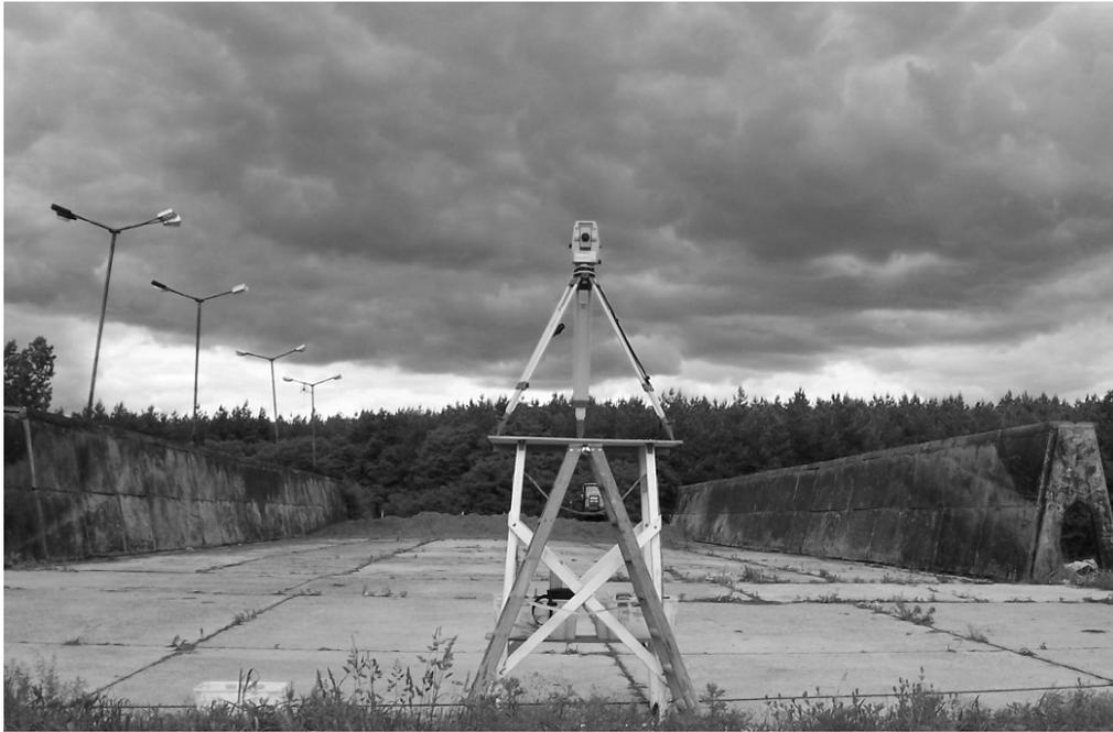
Abb. 37: Theodolit Leica TPS 1100 bei der Vermessung
