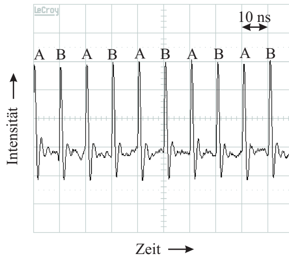
Abbildung 6.3: Eine der möglichen Emissionscharakteristika des Nd:YVO 4 -Oszillators nach dem Einbringen der RTP Pockels-Zelle in den resonatorinternen Strahlengang. Die Abbildung zeigt einen stabilen Doppelimpulsbetrieb mit zwei äquidistanten Impulsen A und B gleicher Intensität. Die Repetitionsrate des Oszillators ist somit auf 100 MHz verdoppelt.
