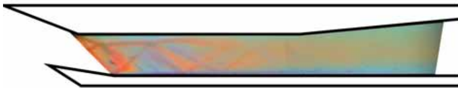
Abbildung 4.10: Gedrosselte Einlaufströmung ( M_\infty = 2,5 ; l = 79,3\text{mm} ; \Delta = 78\% )
