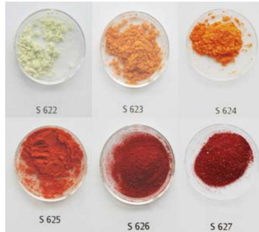
**Abbildung 6-16:** Farbabstufungen der Mn-dotierten Zinkoxidsulfide. Mn-Dotierung: 0, 0,5, 1, 2, 5, 10 mol% (aufsteigend mit Bezeichnung der Probe).
