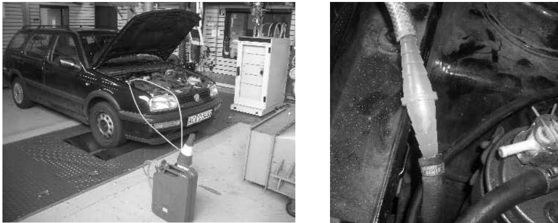
Abb. 59: Links wird eine Mikroemulsion an einem Rollenprüfstand beim TÜV (Essen) geprüft. Rechts ist der Rücklauf des klaren Diesel-Mikroemulsions-Kraftstoffes zu sehen.
