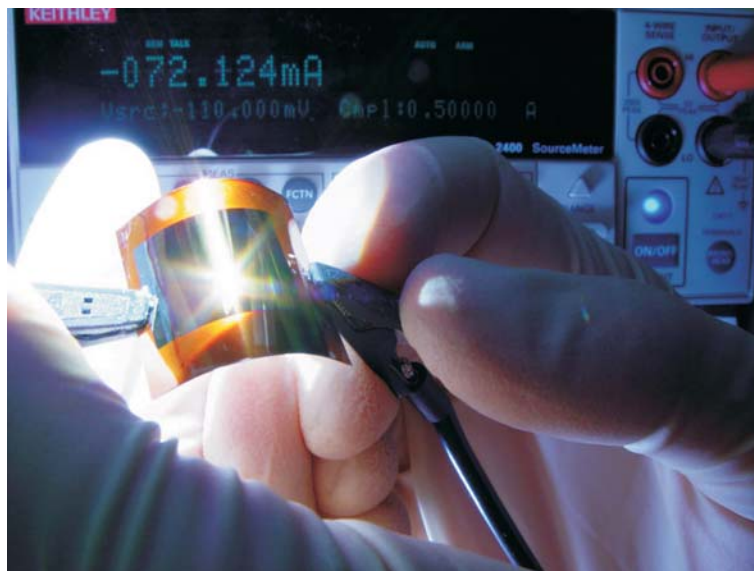
Abbildung 1.1.: Organische Solarzelle mit einer Fläche von 2 \text{ cm}^2 auf einem flexiblen Substrat (Stahlfolie).
