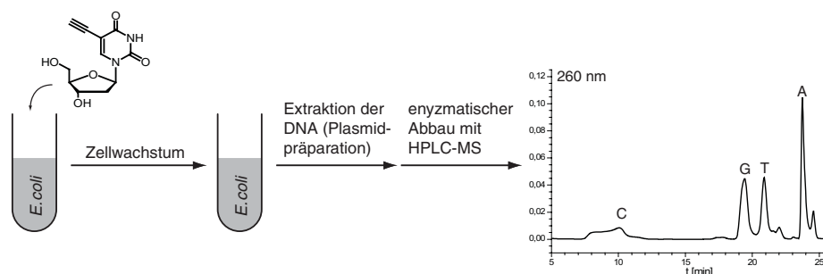
Abbildung 4.35: Assay zur Untersuchung vom Einbau modifizierter Thymidine durch E.coli -Zellen. [174]
