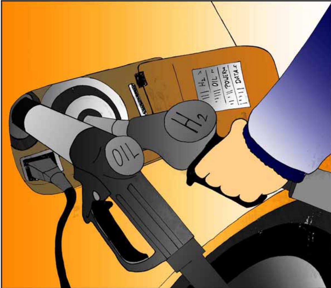
Abbildung 3: Docking-Station für alle wichtigen Betriebsmittel des Fahrzeugs an einer Stelle
