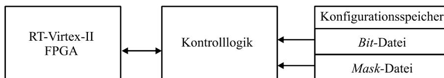
**Bild 4.10: Readback-Verfahren zur Überprüfung der Konfiguration**
