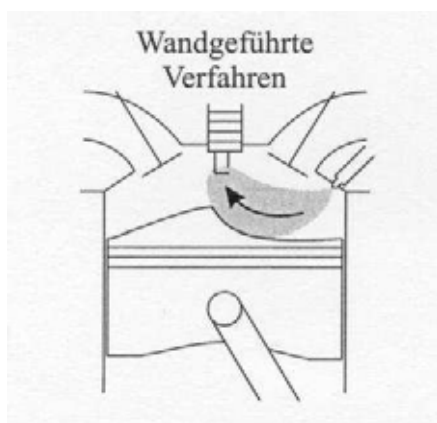
Bild 2.3: Wandgeführte Brennverfahren [Mer]
