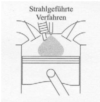
Bild 2.5: Strahlgeführte Brennverfahren [Mer]
