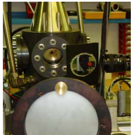
Bild 4.5: Druckkammer in Reflexionsanordnung bei Mehrlochdüse
