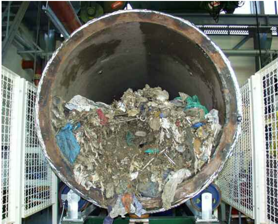
Abbildung 3 Geöffneter Reaktor nach Versuchsende (Inputmaterial: unzerkleinerter Restabfall)
