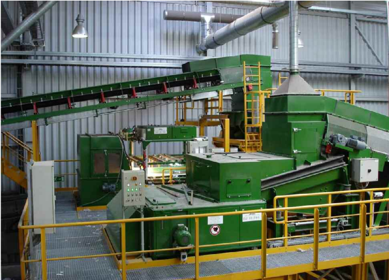
Abbildung 6 Aufbereitung MBA Leipzig/Crobern - optische Sortierung
