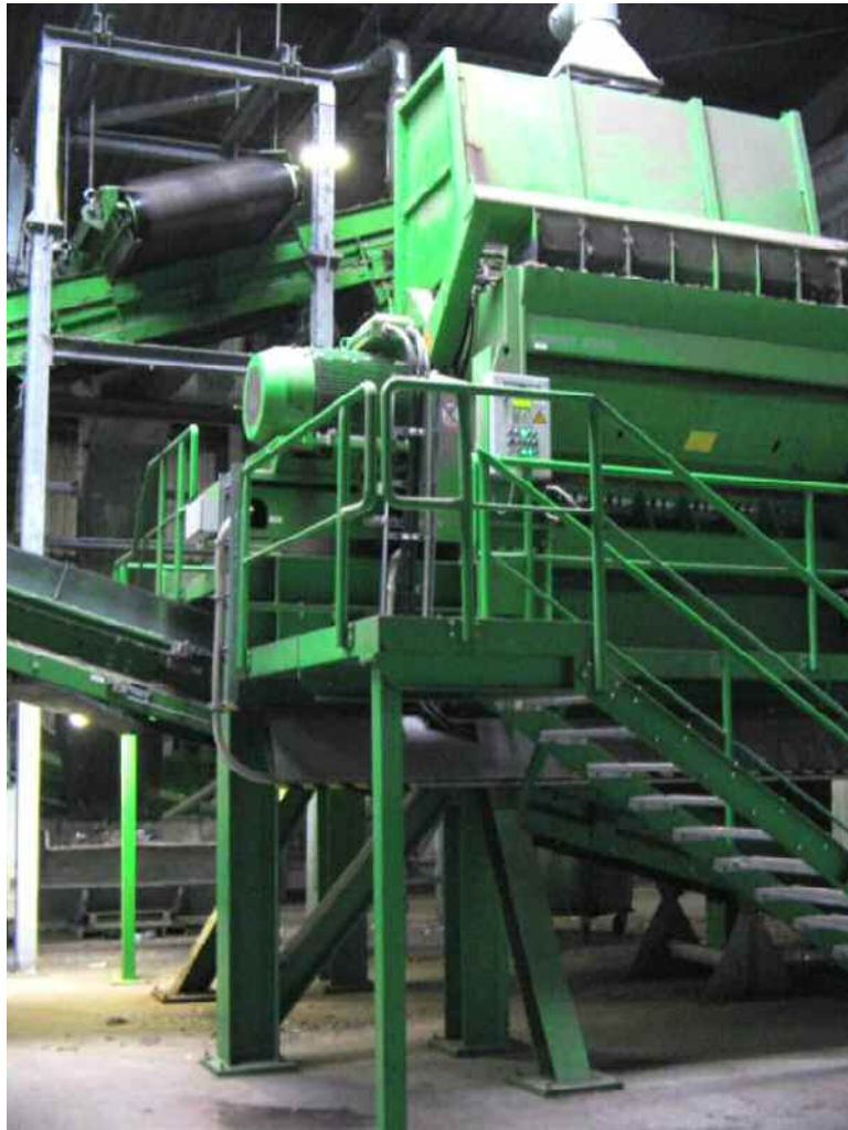
Abbildung 6 Neuer Nachzerkleinerer mit zusätzlichem Magnetscheider in Stralsund
