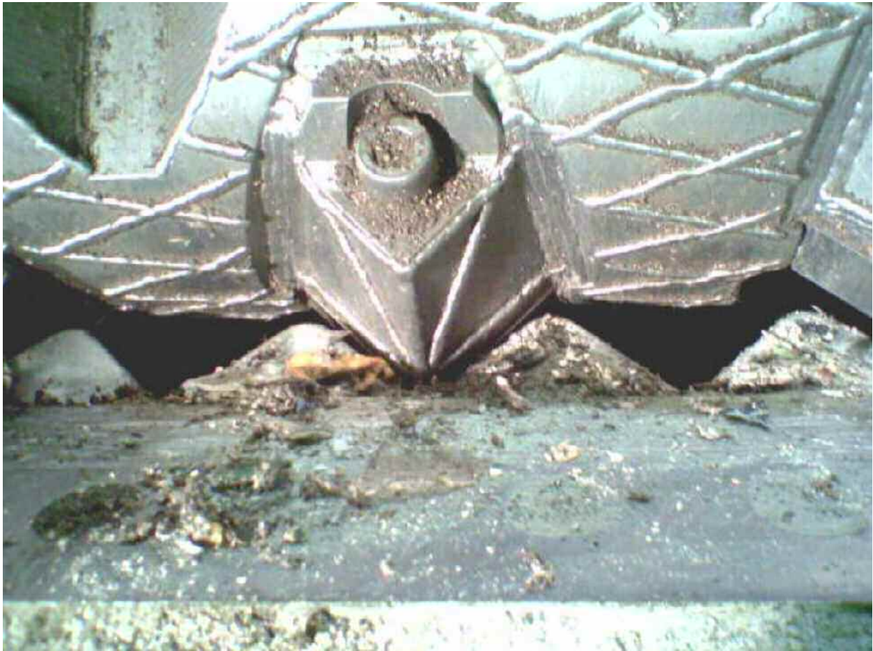
Abbildung 5 Schnittvorgang Rotormesser im Gegenmesser
