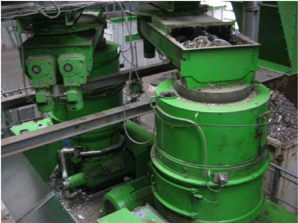
Abbildung 7 Pelletierpressen mit Förder- und Dosierschnecken
