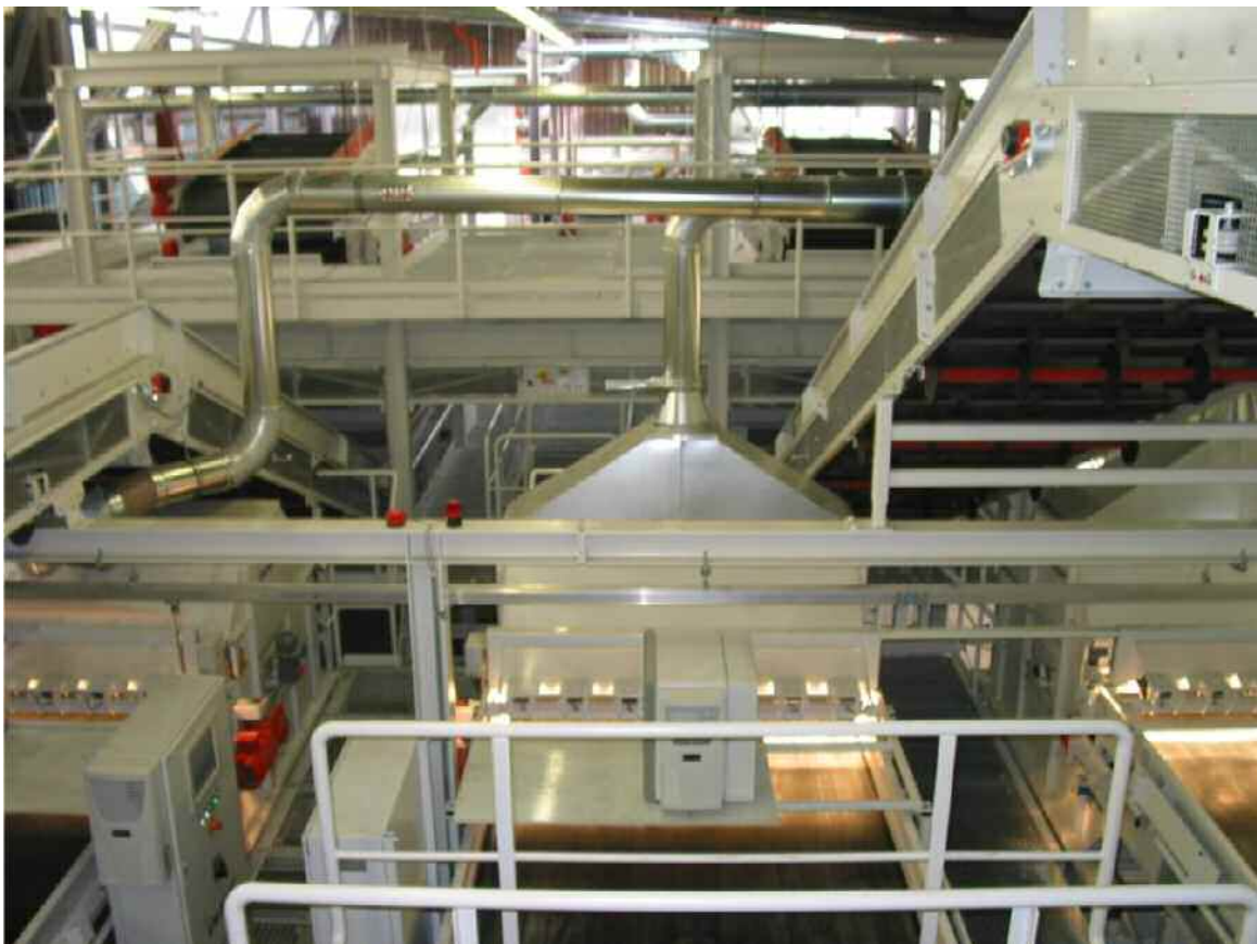
Abbildung 3 Maschinenhalle mit 3 der 4 NIR-Trennern
