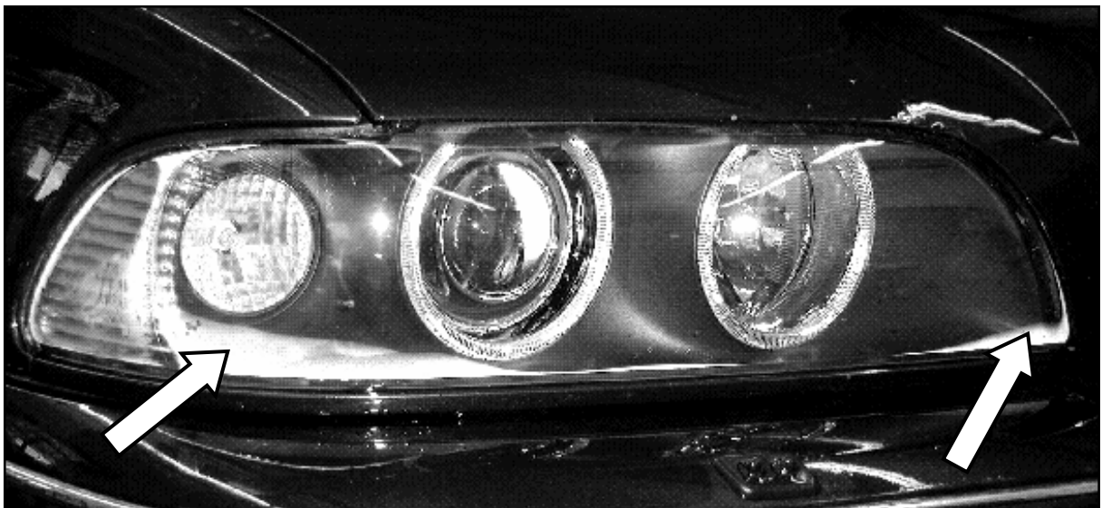
Abbildung 1.1: Kondensatbildung auf der Innenseite der Abschluss-Scheibe eines Kfz-Scheinwerfers
