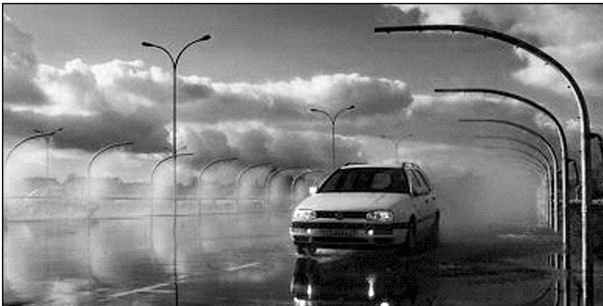
Abbildung 2.3: Gerätetest auf einer Beregnungsstrecke
