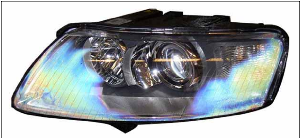
Abbildung 4.5: Farberscheinungen an Kondensat im Scheinwerfer
