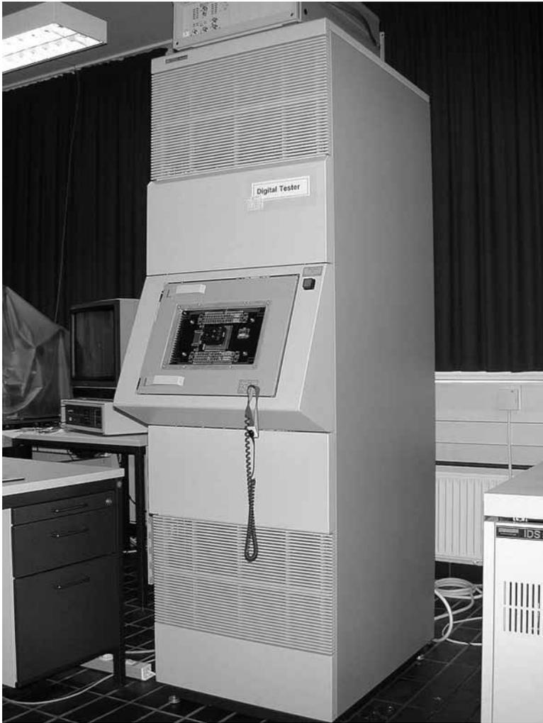
Abbildung 6.11: Digital-Tester HP 82000
