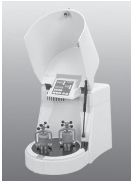
Abbildung 2.16: Planetare Kugelmøhle "Pulverisette 7" der Firma Fritsch. Zur Kompensation der enormen Fliehkräfte ist gegenüber des Mahlbechers ein Gegengewicht montiert.
