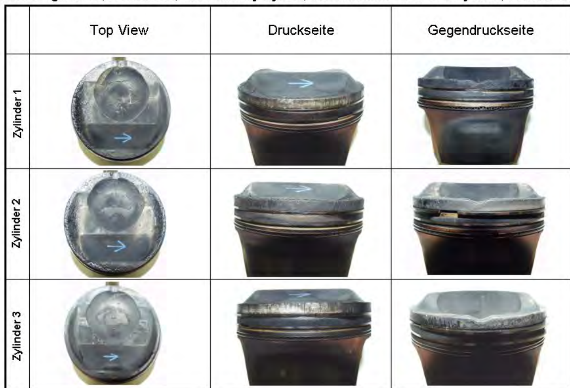
Abbildung 54: Fotografien der Kolben aus Fahrzeug IG240 nach 81.825 km
