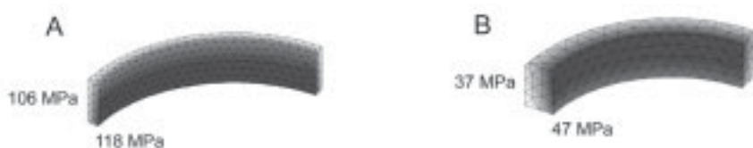
Bild 4.9: 1. Hauptnormalspannung in den Probekörpern bei 100 bar Innendruck.
