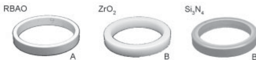
Bild 4.8: Innendruckprobekörper zur Bestimmung der Inertfestigkeit und der Risswachstumsparameter.
