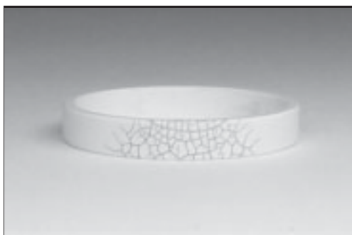
Bild 4.13: Sinterprozessbedingte Rissbildung im RBAO-Probekörper.
