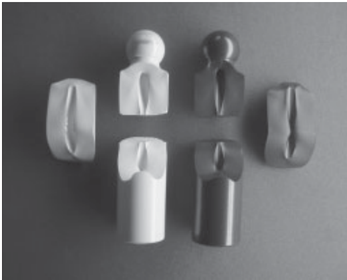
Bild 6.12: Typisches Bruchbild von keramischen Kolben im Proof-Test (Werkstoffe RBAO und s-3A a ).
